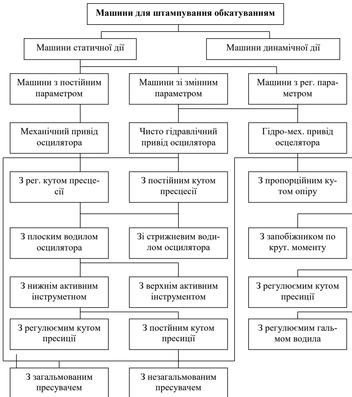
Рисунок 3.6 – Класифікація машин для штампування обкатуванням
